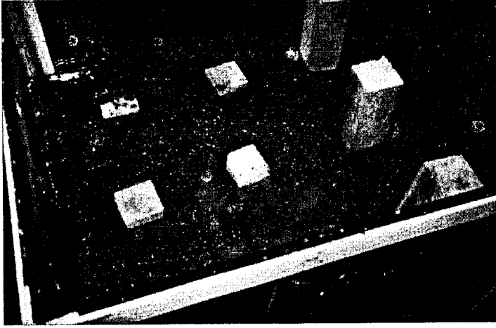
Şekil 9. Kompaksiyon kazıkları ile iyileştirilen zeminde çakma esnasında sıvılaşmanın gözlenmesi.
