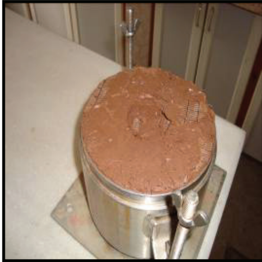
Resim 7. Yalnız Elyaf Katkılı Numune (CBR Deneyinden Sonraki Durum)
