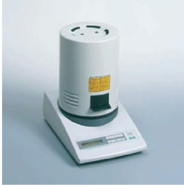
Şekil 2. Kett FD 610 İnfared kurutma cihazı teknik özellikleri
