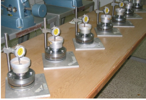
Şekil 2. (a) Tek eksenli şişme aparatlarında emme basıncı ölçümü için numunelerin suya doygun hale getirilmesi, (b) doygun numunelerin 7 kPa altında oda ısısında kurumaları için beklemeye alınması.
