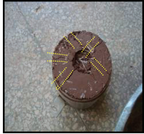
Resim 6. Uçucu Kül-Elyaf Katkılı Numune CBR Deneyinden Sonraki Durum
