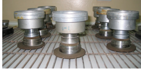
Şekil 2. (a) Tek eksenli şişme aparatlarında emme basıncı ölçümü için numunelerin suya doygun hale getirilmesi, (b) doygun numunelerin 7 kPa altında oda ısısında kurumaları için beklemeye alınması.
