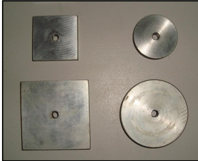
Şekil 5. Model Ankraj Plakaları
