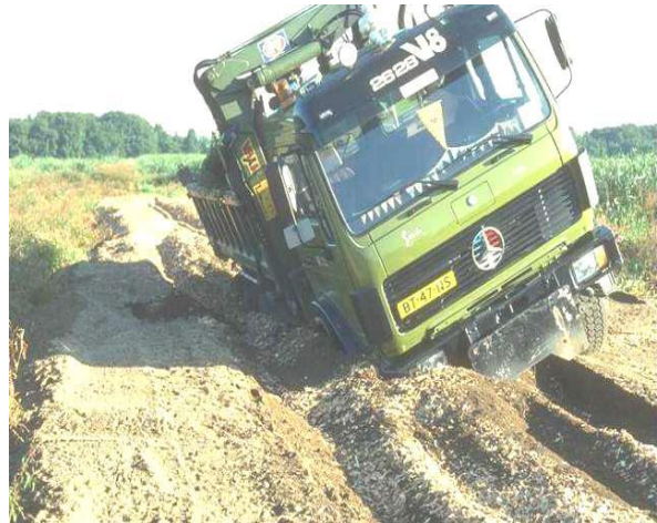
d.,e. Tolerans dışı teker izi oluşumu yani temelin deformasyonu durumunda taşıtların hali
