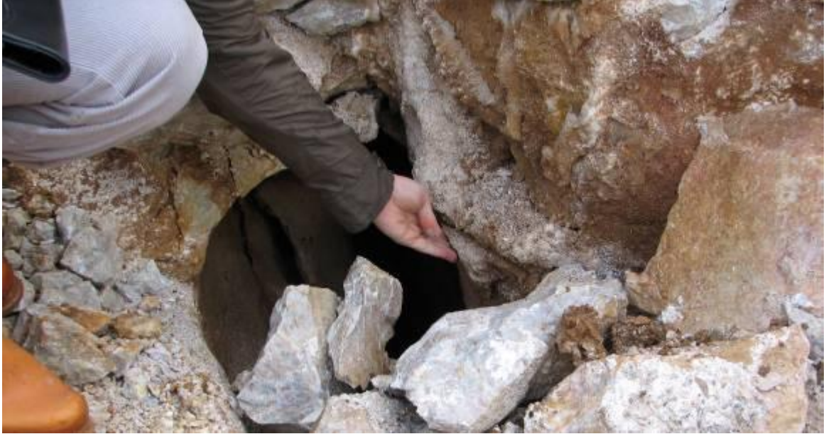
Fotoğraf 9. Susurluk Araştırma Çukurlarında Ayrışmış Kesimlerin Altında Rastlanılan Karstik Boşluklardan Biri (14 Şubat 2009)
