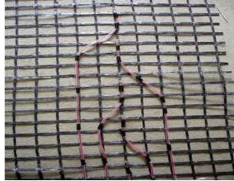
Şekil 4. Geogrid Üzerine Yapıştırılmış Strain-Gauge Ve Bağlantı Kabloları
