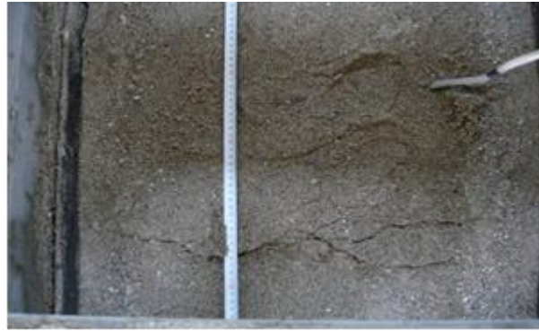
Şekil 8. Yaklaşık 1g Yanal Deprem İvmesi Sonunda Kum Dolgulu Duvar Üst Yüzünde Gözlenen Çatlaklar
