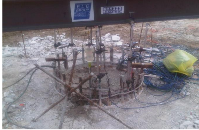
Şekil 5. Referans Kirişi ve LVDT'ler
