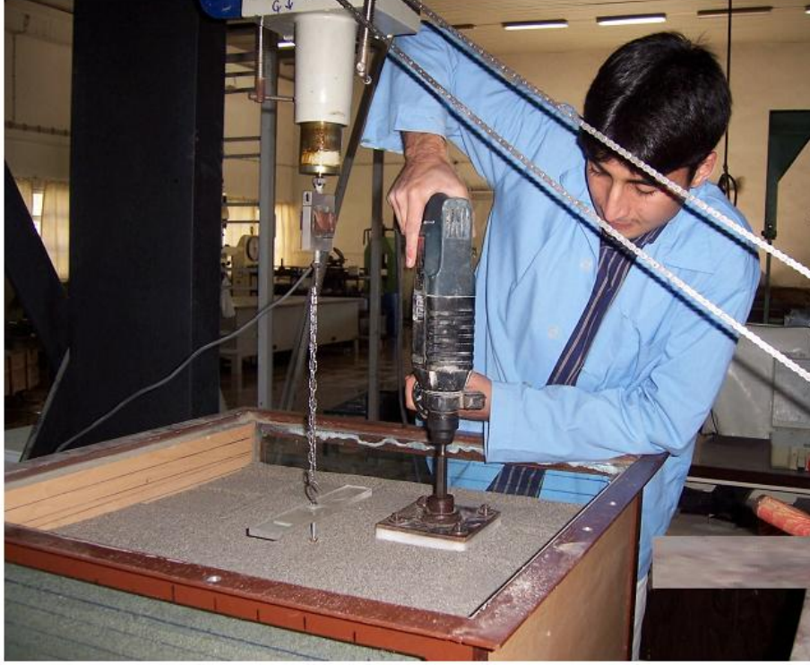
Şekil 2. Kum Zeminin Kasa İçerisine Yerleştirilmesi (Demir, 2006)
