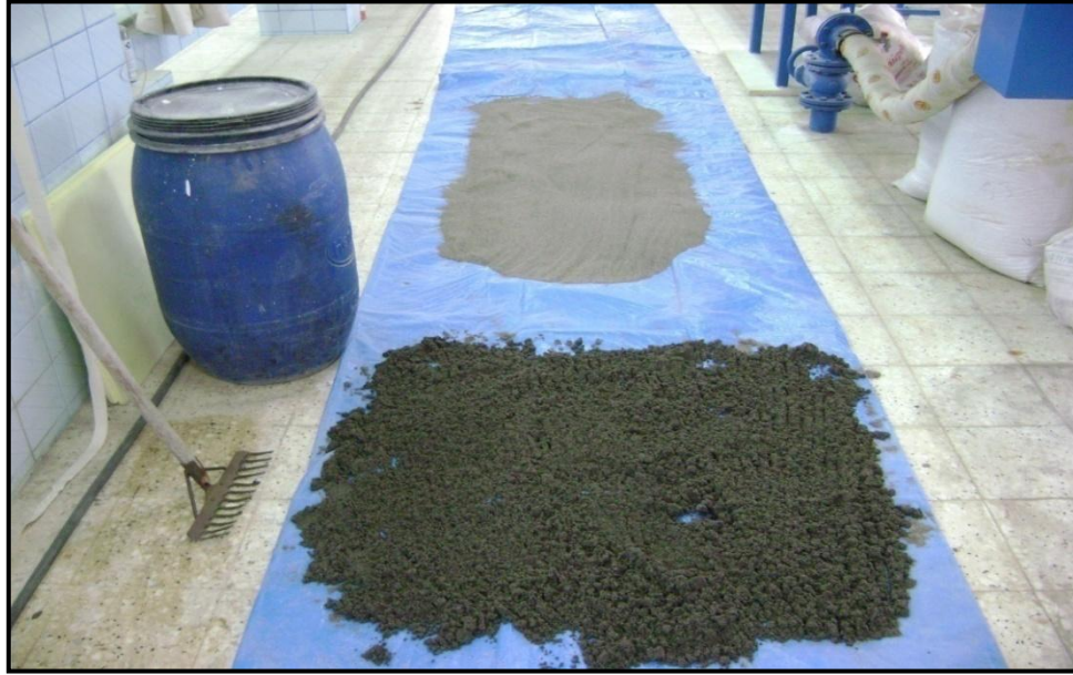
Şekil 6. Deney Kumunun Kurutulması
