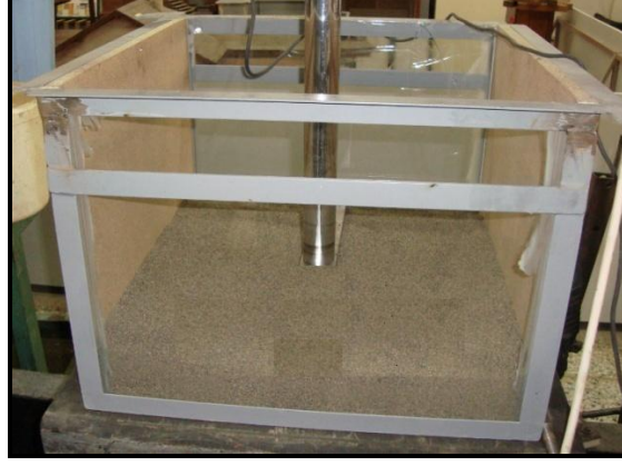
Şekil 2. Deney Kasası (Bağrıaçık, 2010)
