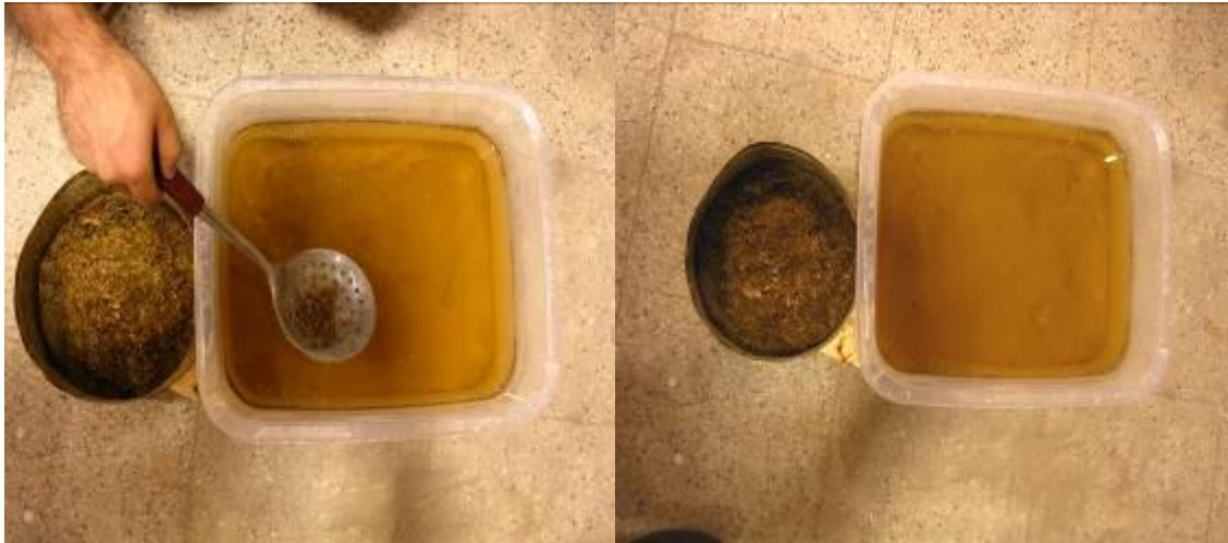
Şekil 8. Süzgeç ile Samanların Alınması ve Saman ile Zeminin Ayrışmış Hali
