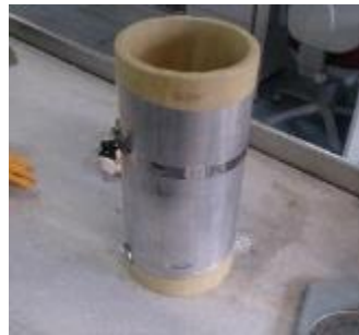
Şekil 6. a) Numunenin Sıkıştırılacağı Mold b) Numunenin Sıkıştırılması
