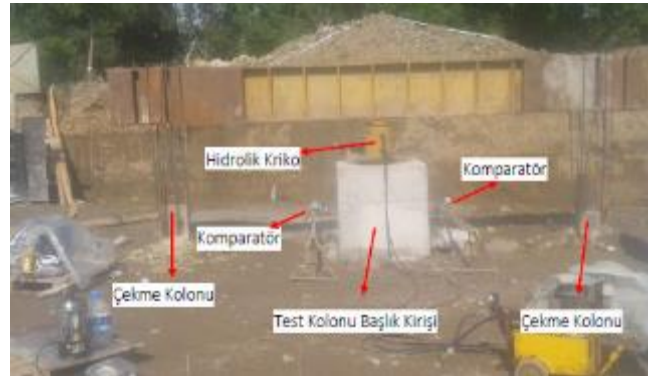
Şekil 4. Derin Karıştırma Kazığı Yükleme Deney Düzeneği
