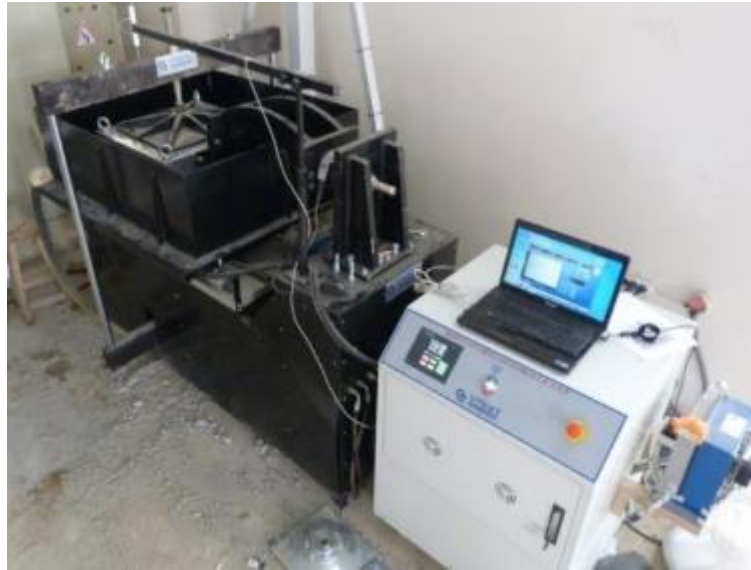
Şekil 1. Büyük Ölçekli Kesme Kutusu
