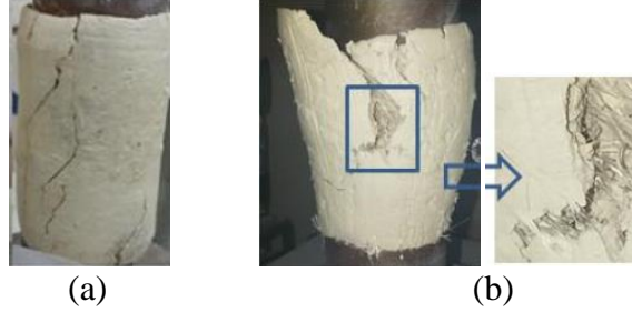
Şekil 3. (a) Fiber Katkılı Bir Örneğin Serbest Basınç Deneyi Sonucundaki Varilleşerek Kırılması, (b) Köprüleme Etkisinin Gözlenmesi
