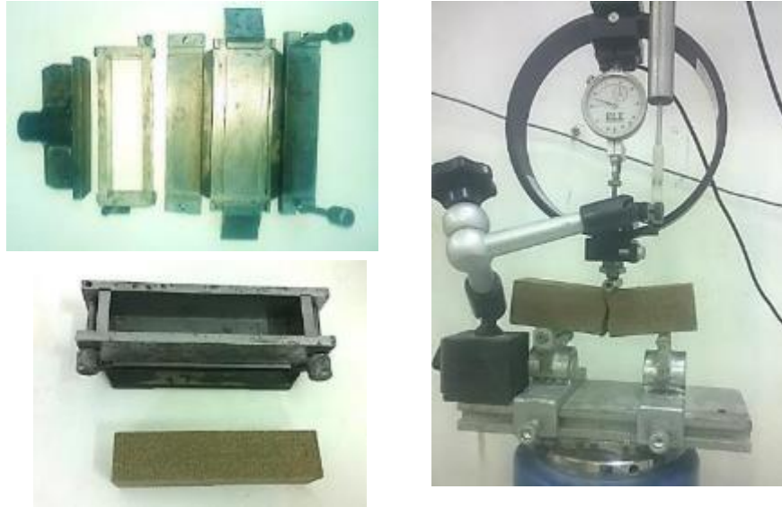
Şekil 1. Eğilme Deneyi Prizma Numune Hazırlama Kalıbı Detayları ve Deney Düzeneği
