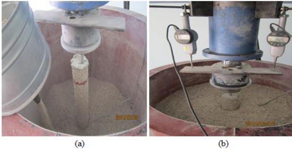
Şekil 6. a) Deney Kumunun Tanka Yerleştirilmesi, b) Kazık Yükleme Deneyi
