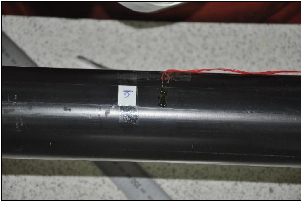
Şekil 3. Boruda Oluşan Gerilmelerin Ölçümü İçin Kullanılan Gerinim Pulları
