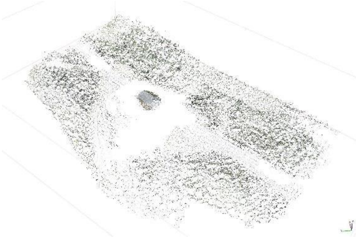
Şekil 3. Yaklaşık 45000 Noktadan Oluşan Kaba Nokta Bulutu
