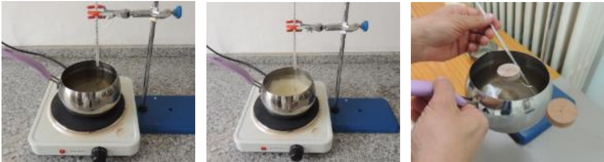
Şekil 1. Parafinin Erime ve Katılaşma Sıcaklıklarının Ölçülmesi
