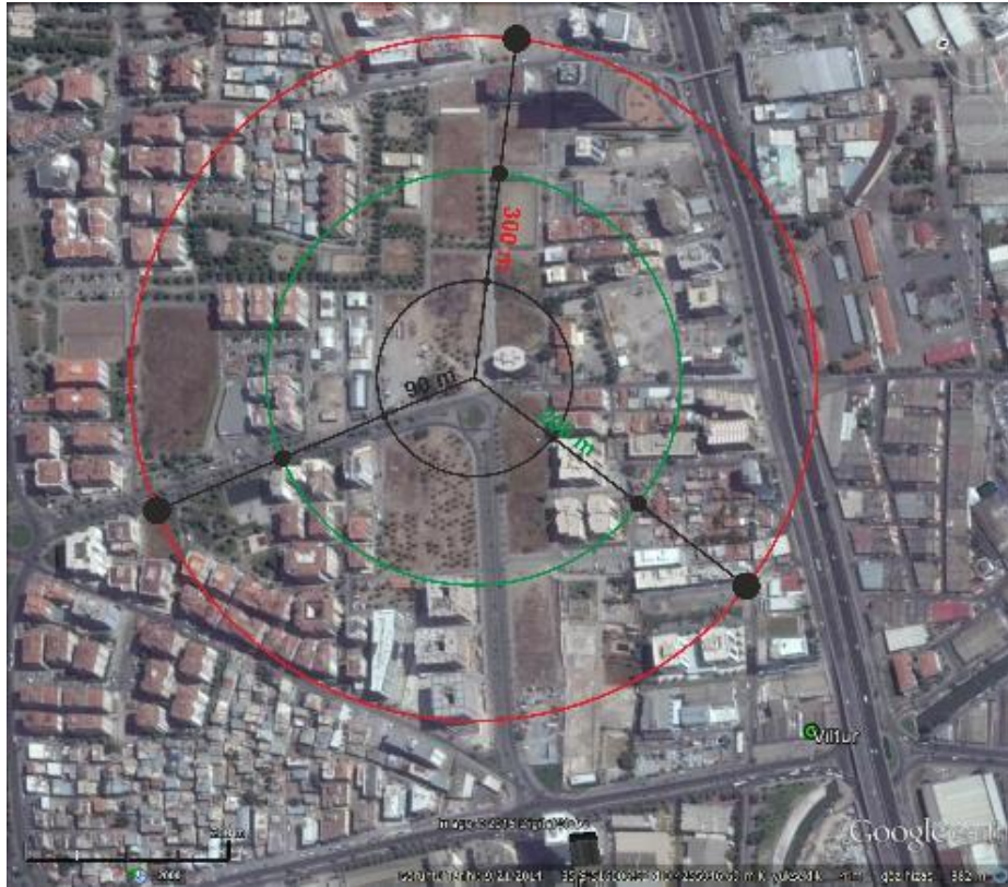
Şekil 3. SPAC Çalışma Geometrisi
