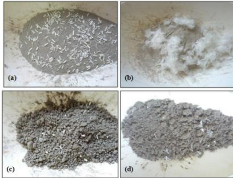
Şekil 2. Donatılı Numune Hazırlanışı Kuru Durumda a) 4 mm telek ve b) Tüy Lifi; Optimum Su İçeriğinde c) 4 mm telek ve d) tüy lifi
