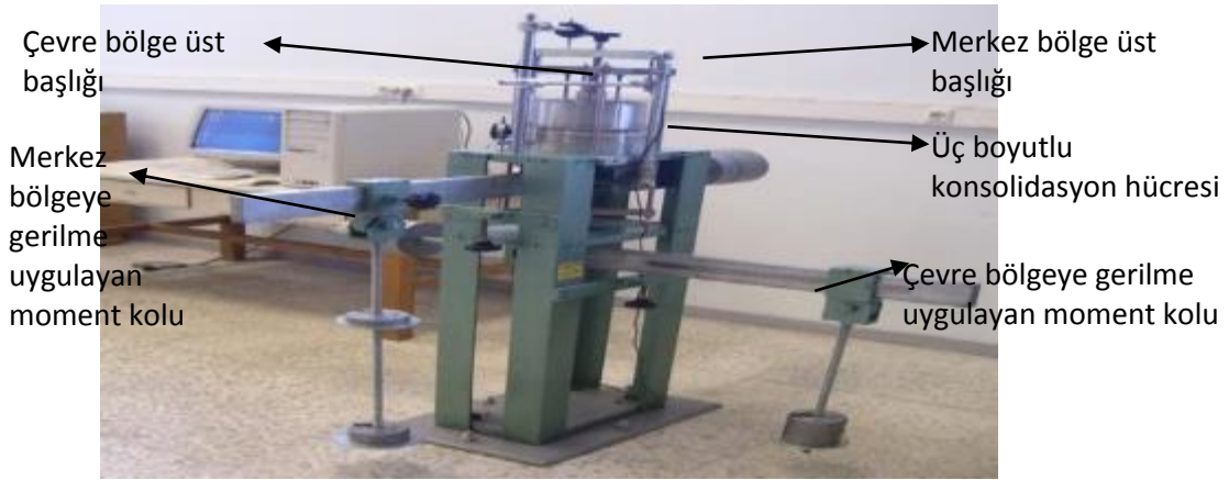
Şekil 2. Üç Boyutlu Konsolidasyon Deney Aleti
