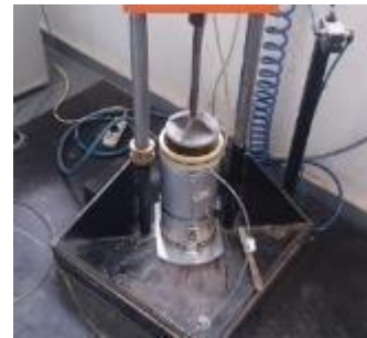
Şekil 6. a) Numunenin Sıkıştırılacağı Mold b) Numunenin Sıkıştırılması
