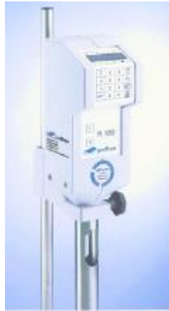
Şekil 3. ProRheo R180 Deney Aleti, Almanya.
