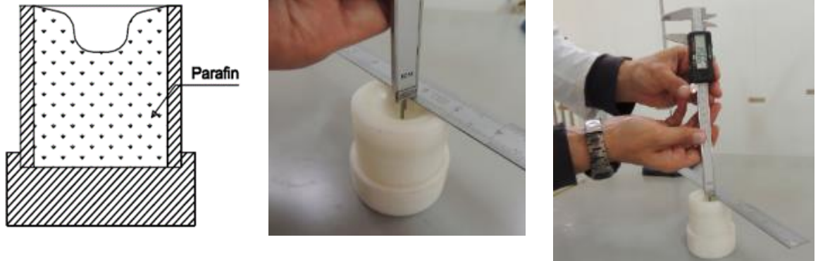
Şekil 3. Parafinin Ortasında Meydana Gelen Çöküntünün Şematik Görünümü ve Bu Çöküntünün Derinliğinin Ölçülmesi
