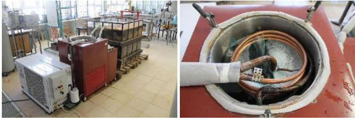
Şekil 1. a.Zemin Dondurma Sistemi; b.Soğutma Haznesi
