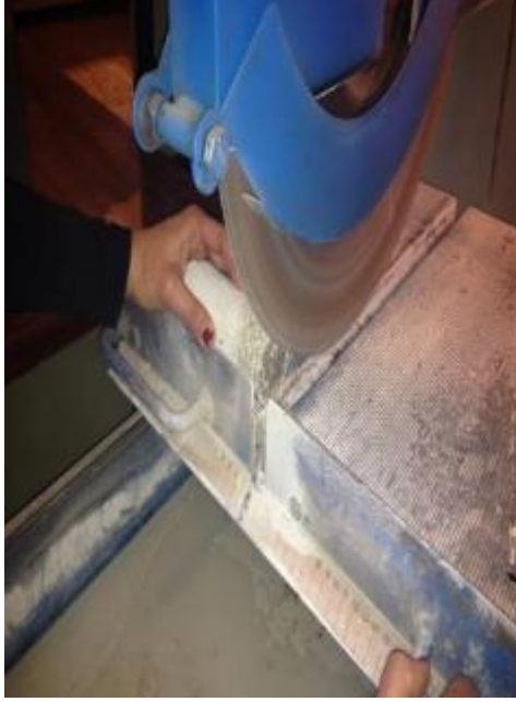
Şekil 4. Taş Kesme Makinası ile Numunelerin Kesilmesi
