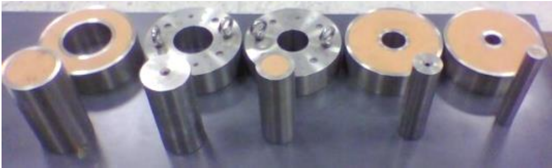
Şekil 3. Numunenin Çevre Bölgesine Gerilme Uygulayan Başlıklar ile Merkez Bölgeye Gerilme Uygulayan 20, 30, 40, 50 ve 60 mm Çapında Pistonlar
