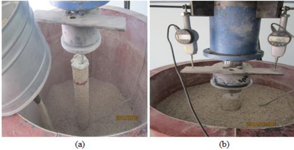
Şekil 3. a) Deneysel Kumun Tankta Yerleştirilmesi, b) Kazık Yükleme Deneysel
