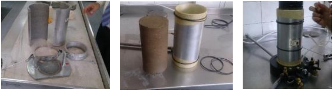
Şekil 3. Deney Numunesinin Membran İçine Alınması
