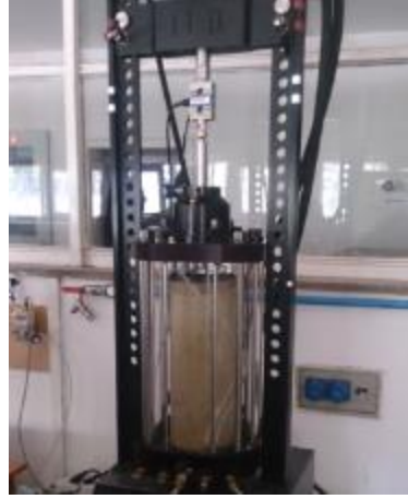
Şekil 4. Zemin Numunesinin Deney Sistemine Yerleştirilmesi
