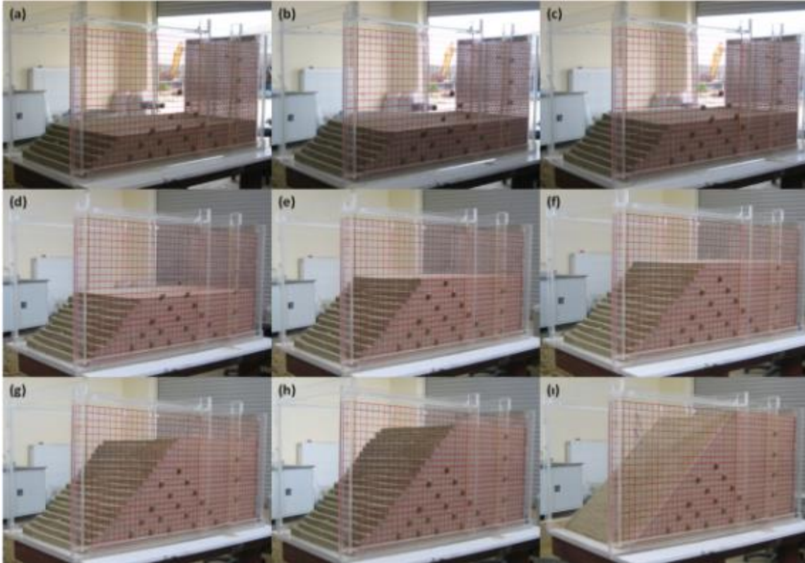
Şekil 2. Üç Boyutlu Zemin Kutusunda 2.5 cm Kalınlığında Tabakalar Halinde Yapılan Kontrollü Sıkıştırma İşlemi Neticesinde Oluşturulan Şevin İmalat Adımları: (a - h) Sıkıştırma Sonrası Sırasıyla 6., 7., 8., 10., 13., 15. ve 20. Katmanlar; (i) Sıkıştırma Sonrası 22. Katman (toplam şev yüksekliği 22 x 2.5 cm = 55 cm)
