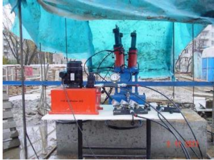
Şekil 10. Deneme Ankrajları İçin Germe Testi Düzenegi
