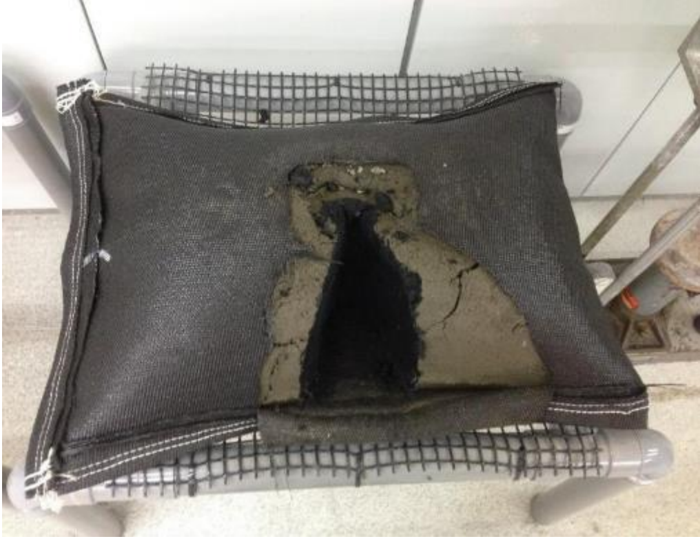
Şekil 3. GDT Deneyleri Sonrasında Torba İçindeki Zemin Görünümü
