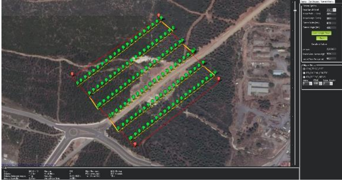
Şekil 2. Uçuş Planlaması ve Fotoğraf Çekim Konumlarının Belirlenmesi
