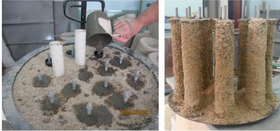
Şekil 2. a) Kazıkların Zemin İçerisinde İmal Edilmesi, b) Kazıkların Zeminin İçinden Çıkarılması
