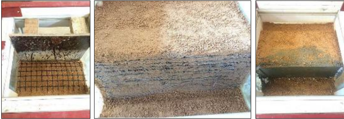
Şekil 3. Geogrid ile Şev Yapımı
