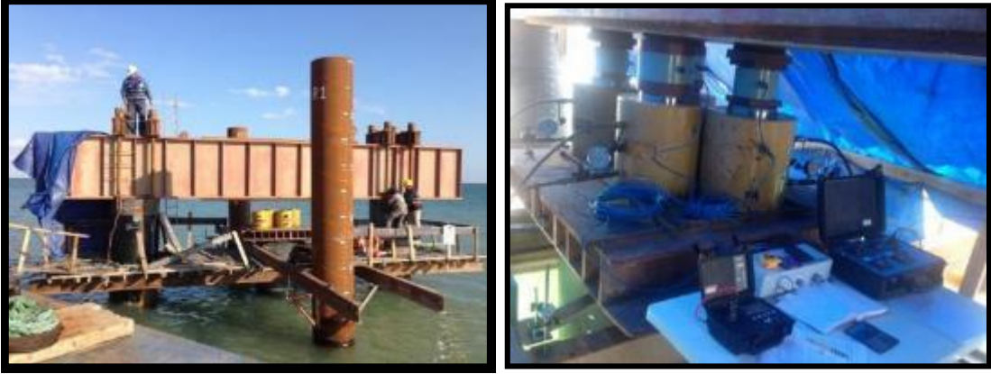
Şekil 6. 1219 mm (T2) Çaplı Kazık için Yükleme Deneyi Aşamaları
