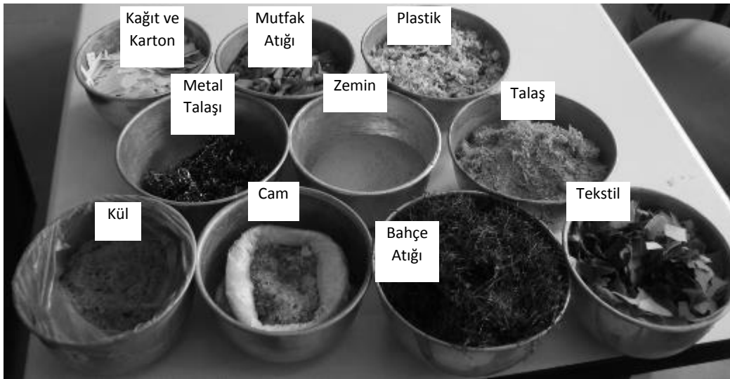
Şekil 1. Sentetik KKA Numunelerinin Üretiminde Kullanılan Malzemeler
