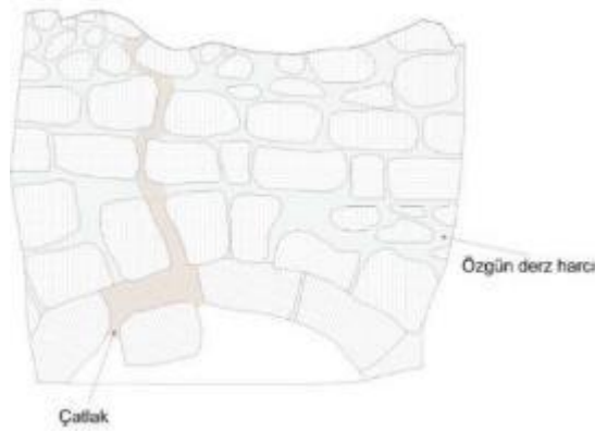
Şekil 22. Güney duvarı kemer çatlakları.
