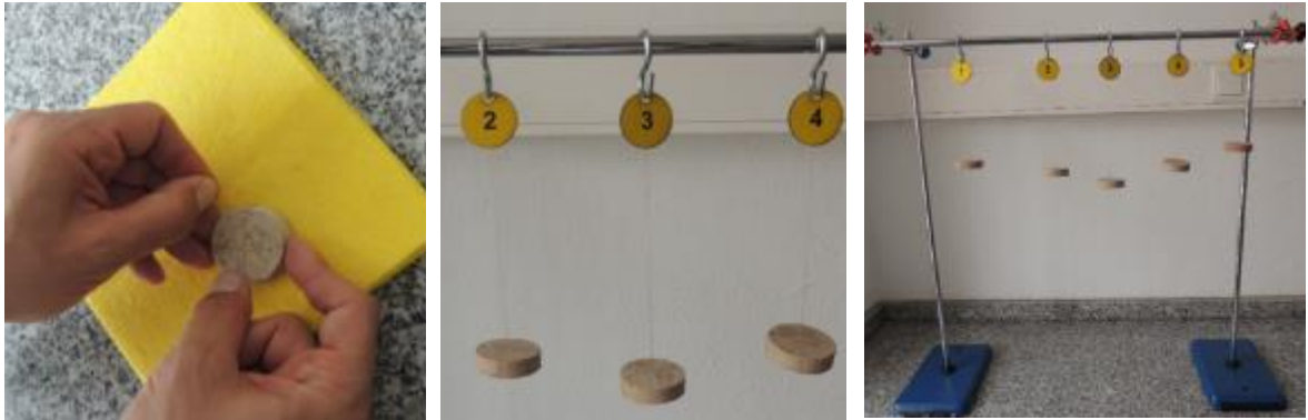
Şekil 7. Örneğin Bağlanması, Kancalarla Askı Çerçevesine Asılması ve Numaralandırılması
