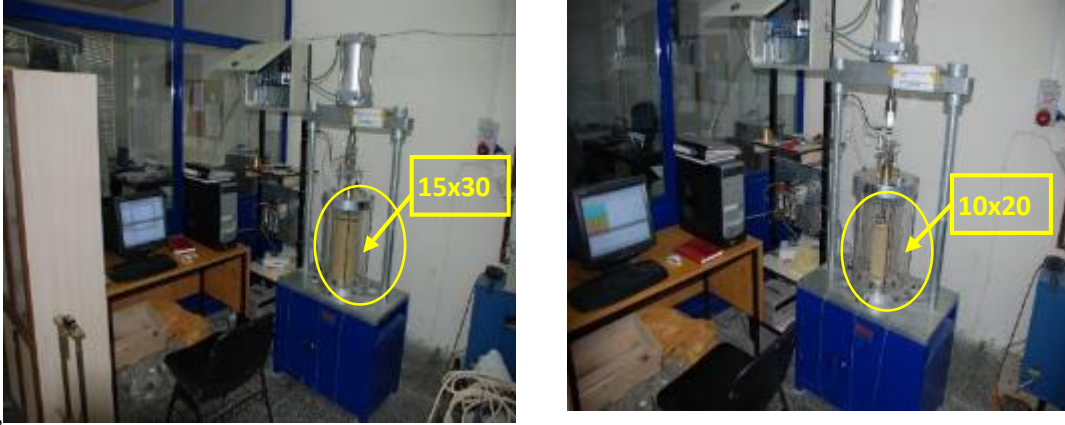
Şekil 2. ÜETY Görünümü ve Test Altındaki Malzemeler; Temel (Sol) Taban Zemini (Sağ) [20]
