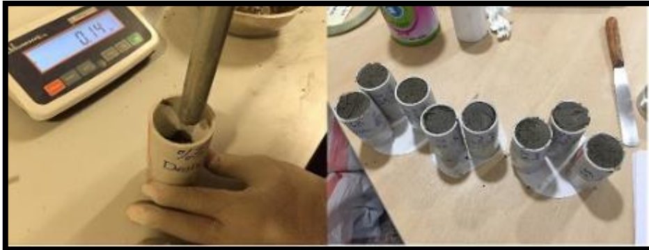
Şekil 1. Tarama Zemininin Kalıplara Yerleştirilmesi
