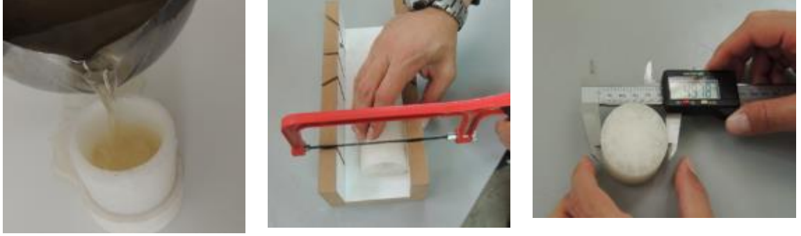
Şekil 2. Parafinin Birim Hacim Kütlesinin Belirlenmesi
