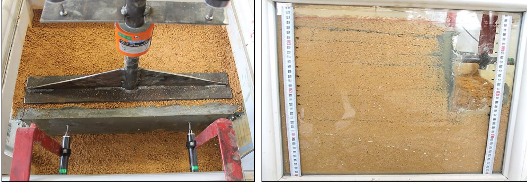
Şekil 7. Göçme Mekanizmaları (üst ve yan görünüş); a-b. Donatısız Şev, c-d. Geotekstil Donatılı Şev, e-f. Geogrid Donatılı Şev ve g-h. Çelik Donatılı Şev (Devamı)
