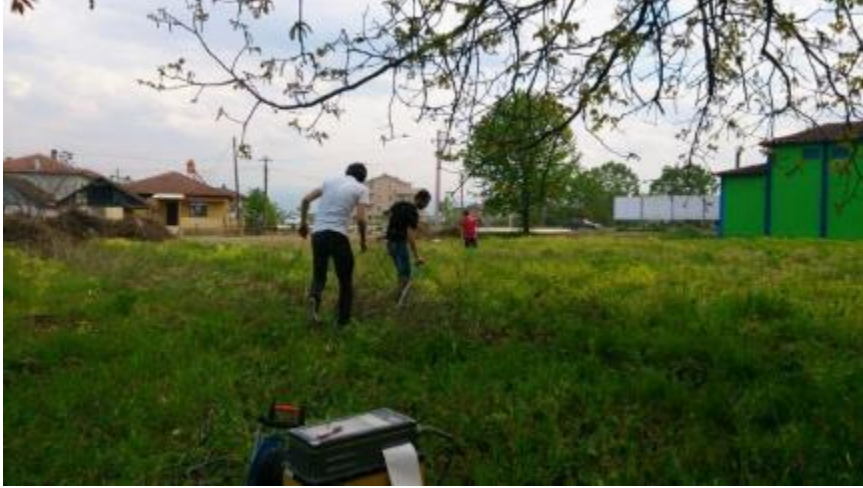
Şekil 6. MASW Ölçümlerinden Bir Görünüm
