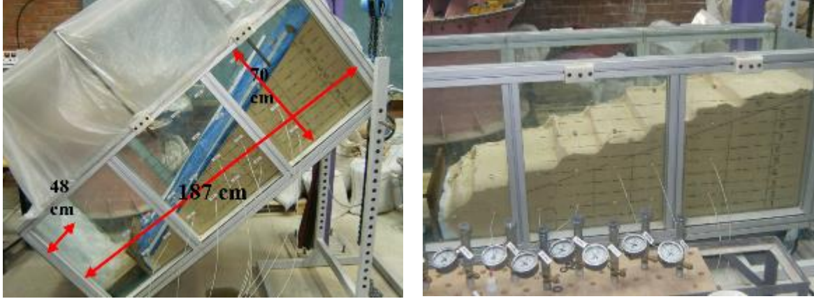
Şekil 6. Model Şev Düzenegi Ve Numune Hazırlanmasından Görüntü
