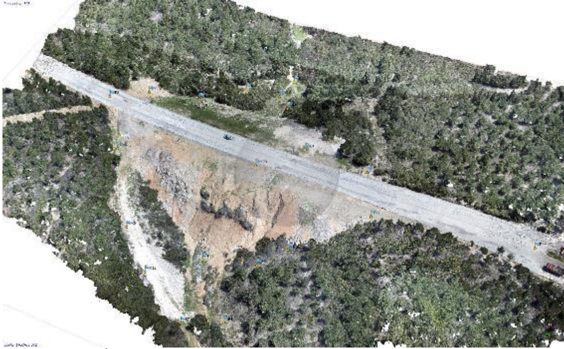
Şekil 5. İncelenen Şevin Sıklaştırılmış Nokta Bulutu (Dense Point Cloud)
