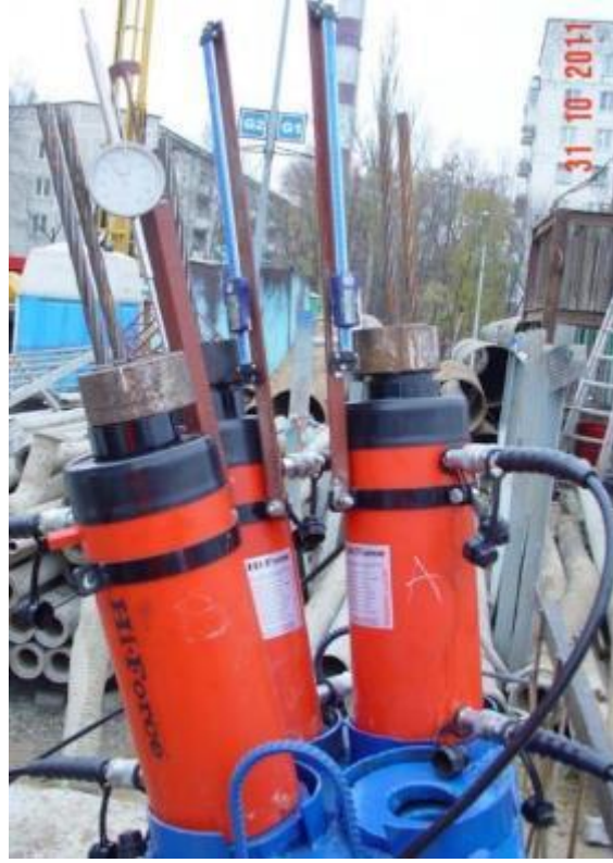
Şekil 4. SBMA Tipi Ankraj Germe Krikosu
