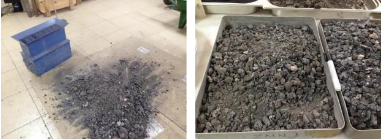
Şekil 2. Standart Proktor ve CBR Deneylerinde Kullanılan Malzeme
