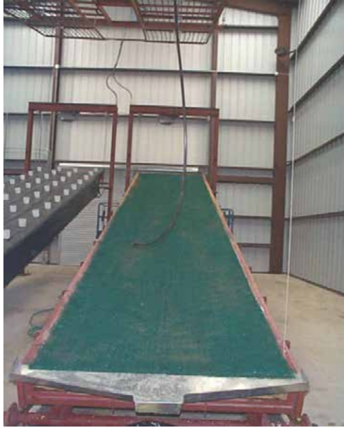
Şekil-3. Standart deney düzeneğinin eğimli uzunluğu 22.13m, genişliği 1.83m olup %9 eğime sahiptir (Renard, 1985)
