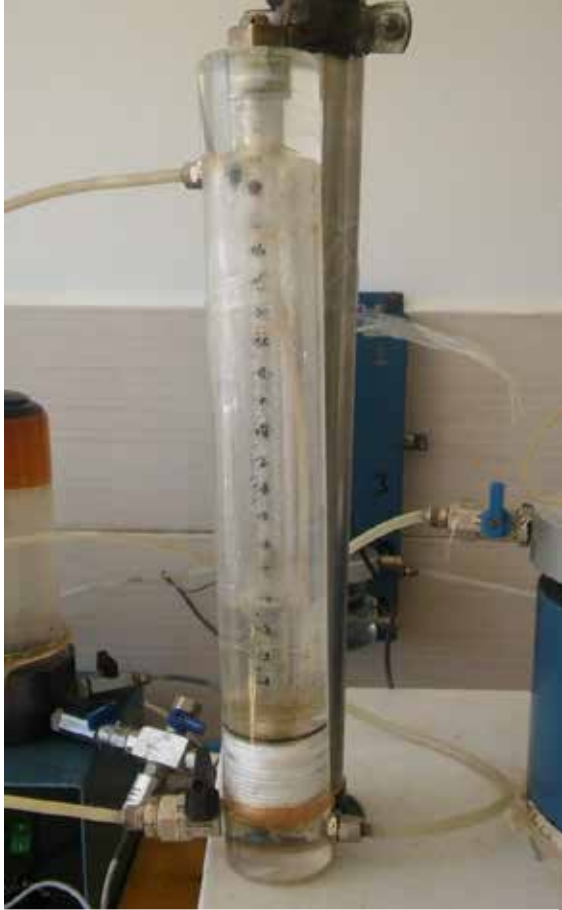
Şekil 3. Yıkama sistemi ünitesi, seramik taş ve seramik taşın yerleştirildiği helezon taban
