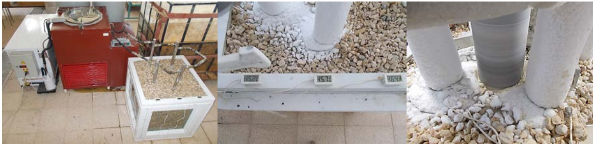
Şekil 3. Yapay Zemin Dondurma ve Karot Alma İşlemleri
