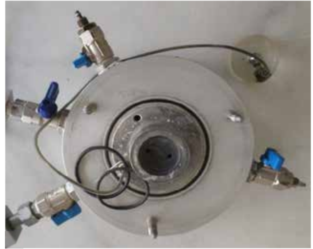
Şekil 3. Yıkama sistemi ünitesi, seramik taş ve seramik taşın yerleştirildiği helezon taban
