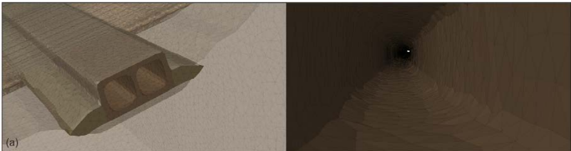
Şekil 9. Marmaray batırma tüneli 3B SE ağında (a) tünel kesitinin yakından görünümü, (b) tünelin içten görünümü
