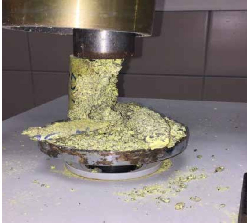
Şekil 5. Serbest Basınç Deneyi Sonucunda Gevrek Kırılan Numune
