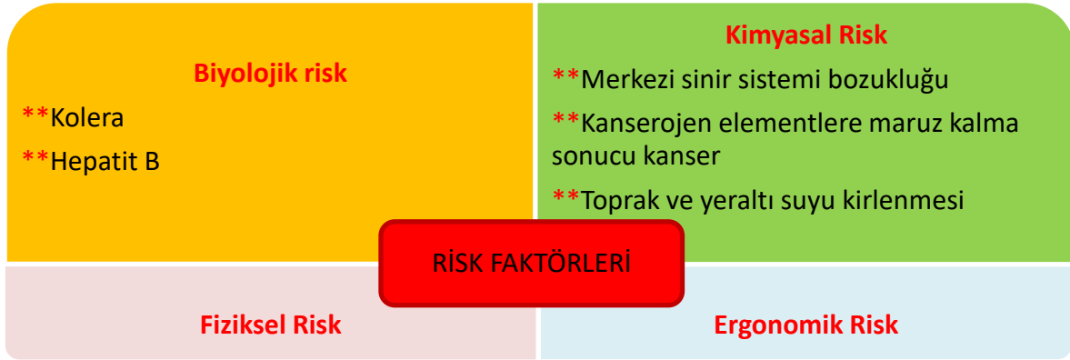
Şekil 1. İnşaat – yıkıntı atıklarında bulunan risk faktörleri
