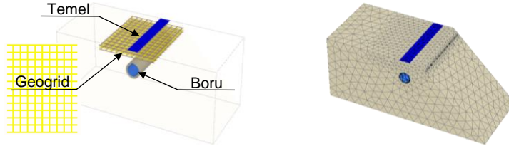
Şekil 3. Sayısal analiz modeli
