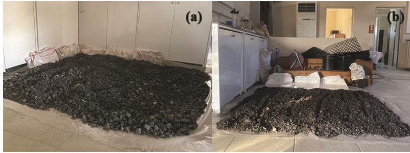
Şekil 1. (a) Plentmiks Temel Malzemesi, (b) Kazınmış Asfalt Malzemesi
