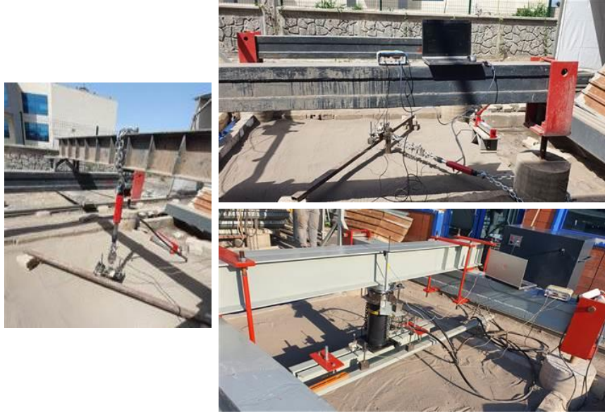
Şekil 11. Farklı yüklemeler altında helisel kazık yükleme deneyleri
