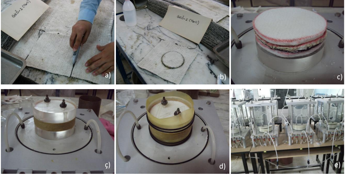
Şekil 8. GKÖ'lerin hidrolik iletkenlik deneyi için hazırlanması: a) rulodan 200mm×200mm boyutlarında numune kesme, b) kesilen numuneden ıslatılarak dairesel örnek alınması, c) GKÖ'nün altına ve üstüne örgüsüz geotekstil yerleştirme, ç) kenardan sızmayı önlemek için GKÖ yan yüzlerinin bentonitle sıvanması, d) numune çevresine lateks membran ve O-halka geçirilmesi ve e) permametrenin yerine yerleştirilmesi.
