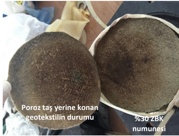
Şekil 14 Sızıntı suyu süzdürülen %30 bentonite sahip zeolit bentonit karışımının (%30 ZBK): a) hidrolik iletkenlik davranışı ve b) numune ve geotekstilde meydana gelen bakteri oluşumu.
