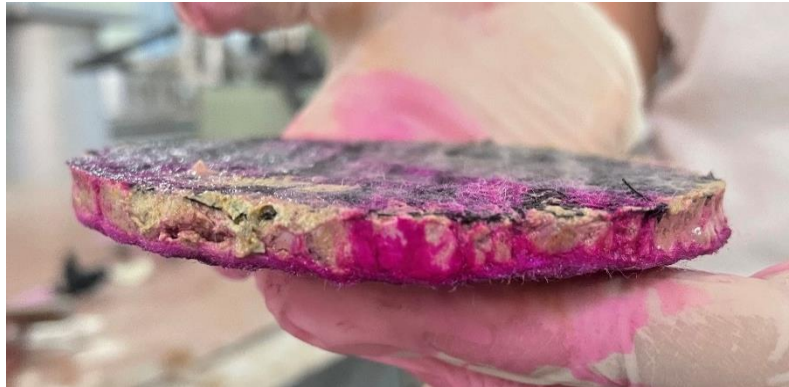
Şekil 9. Hidrolik iletkenlik deneyi sırasında GKÖ kenarından sızma gerçekleşmesi ve bu durumun boya testi ile ortaya konması
